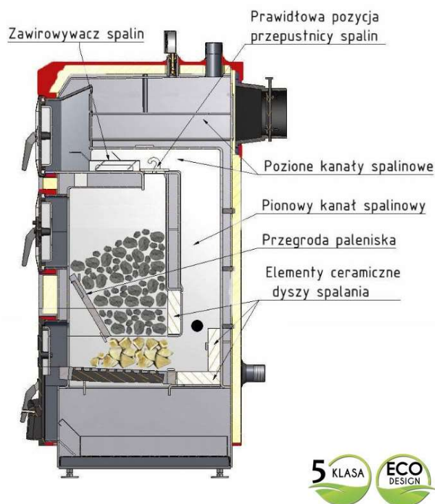
Rysunek 6.1. Schemat kotła węglowego 5 klasy i ekoprojektu
